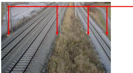
Als BB-Art „Bahn“ ist die gesamte Fläche bis zum Übergang in andere Bodenbedeckungsarten zu erheben.
